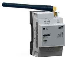
Сетевой шлюз ПВ210 предназначен для подключения приборов ОВЕН с интерфейсом RS-485 к облачному сервису OwenCloud по технологии Wi-Fi.
