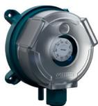
РД30-ДД – механическое перекидное реле (SPDT) перепада давления в пластиковом корпусе с поворотным указателем для ручной настройки порога срабатывания.
